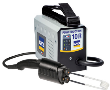
Powerinduction 10 R GYS, Frankrike Induktionsvärmare Modell för hantverkare Levereras med väska och tillbehör Effekt: 1200 W Elektrisk anslutning: 230 V/13 A 6 240:- Art nr 062504
