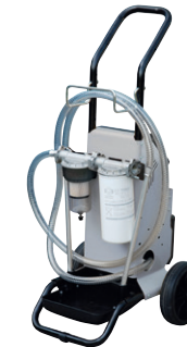
Filteraggregat Piusi, Italien Filtroll, för rengöring av olja och diesel. Flöde: 25 l/min Elektrisk ansl: 230 V Filtrering: 10 my, 2 stegs filtrering 12 085:- Art nr F00506010
