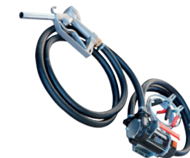
Dieselpumpkit Piusi, Italien Självsugande pump med pistol, bottenventil, filter och 5 m slang Flöde: 50 l/min
