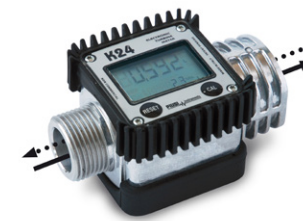
Digitalt räkneverk Piusi, Italien För diesel och spolarvätska. Anslutning 1" utv Max flöde: 120 lit/min Max tryck: 20 bar 1 750:- Art nr F00408100
