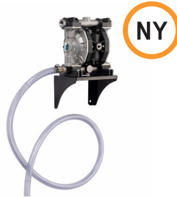
Membranpumpkit för spillolja och diesel Faicom, Italien Tryckluftdriven membranpump. Arbetsstryck: 3-8 bar Flöde: upp till 110 l/min Sughöjd max 6 m Membran i HYTREL Ventiler och ventilsäten i AISI316, Pumphus i AL Anslutning in och ut 3/4" inkl. 2m slang och koppling Max temp 95 grader Väggställare tillkommer
